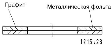
Рис. 14 Уплотнительное кольцо с металлической фольгой
